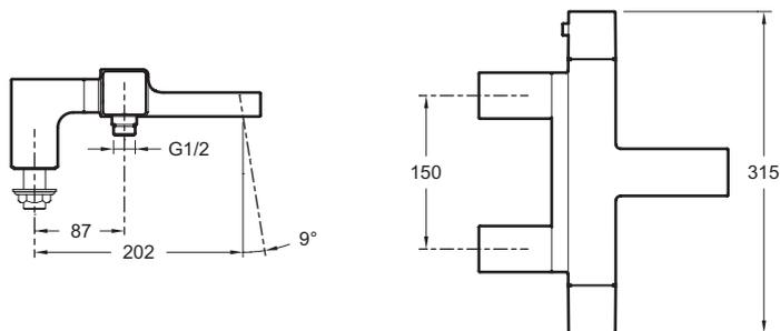
Description : Mitigeur thermostatique bain-douche sur gorge.. E9129. Collection : STRAYT. Poids : 3,5 kg. Normes et réglementations : ACS :. Débit (l/mn sous 3 bars) : 20. Saillie du bec (mm) : 202 mm. Raccords : Avec raccords colonnettes. Mécanisme : Cartouche thermostatique à cire dilatable.. Entraxe (mm) : 150 mm.
